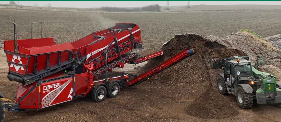
Der **Lepton 5100** ist ein mobiler 4-Fractionen-Scheibenseparator mit 2 Siebdecks zur optimalen Trennung verschiedenster Materialien und zeichnet sich durch höhere Leistungsfähigkeit als herkömmliche Siebanlagen aus.
